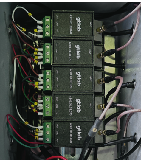
Монтаж вихретоковых формирователей A301 во взрывозащит- ном корпусе
