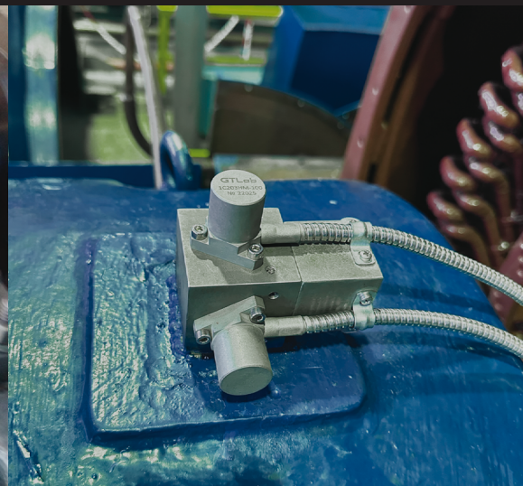
Установка акселерометров 1C203HM-100 на электродви- гатель и редуктор ГПА
