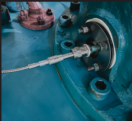
Установка радиальных вихрековых датчиков на нагнетатель ГПА
